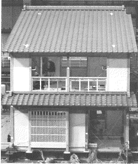
写真4 新築試験体（表側）
